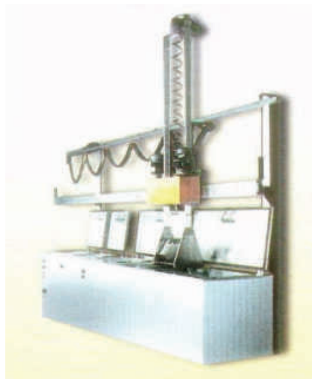
Lavaggio motorizzato con cesto rotante e robot (Settore meccanica di precisione e casalinghi)
